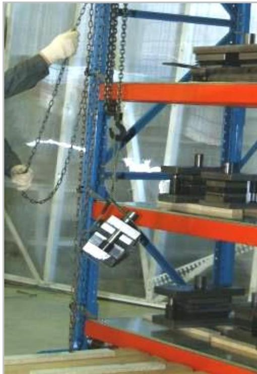
С помощью тали груз поднимется на нужную высоту.
