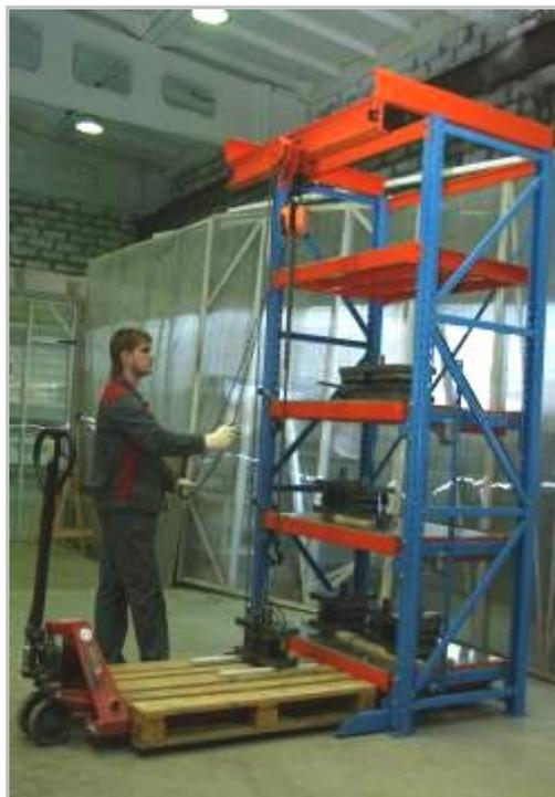
Съемный инструмент (в данном случае штамп) подвозится к стеллажу на тележке. Используя цепь для передвижения каретки по балке, работник перемещает таль в нужной положение. Крюк подъемной цепи зацепляется за вспомогательный трос – обвязку.
