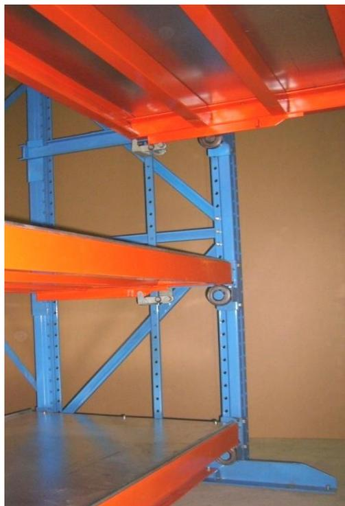
После того, как нужная полка выдвинута, все остальные полки блокируются специальным устройством. Полки могут выдвигаться только по одной.
