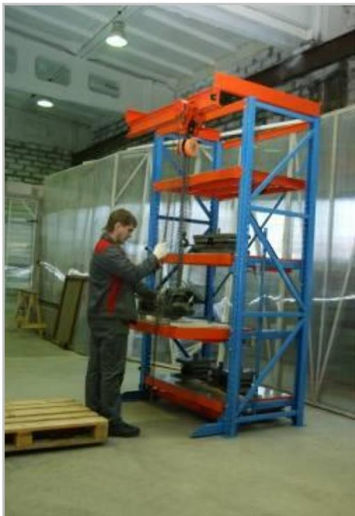
Нужная полка выдвигается и фиксируется стопором в выдвинутом положении. Груз опускается на полку. После того как груз размещен на своем месте – полка задвигается.
