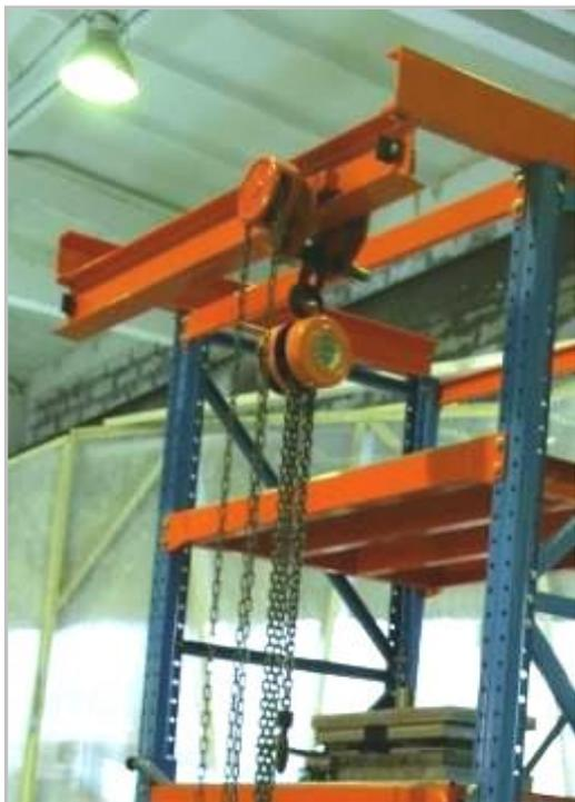
Таль состоит из подвижной части – каретки, которая с помощью цепи перемещается в горизонтальном направлении по балке двутаврового сечения и собственно тали – подъемного механизма с отдельной цепью и крюком.
